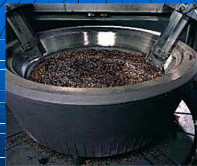
加工 粉碎机 辊筒 \Phi 1700\text{mm} ，淬硬含 镍铸铁60HRC
