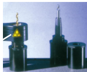
具有相应锥度大小的不同的连接凸缘可装入到夹持套内
