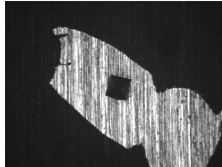
在对切屑进行压痕测试后显示，用Jetstream方式加工得到的断屑脆性更高
